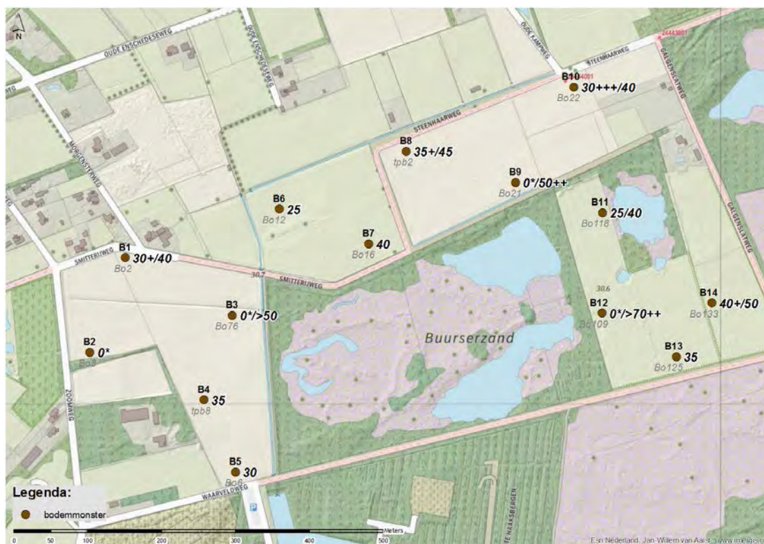
Figuur 15. Overzicht van het ontgrondingsadvies op basis van het bodemchemisch onderzoek. De ontgrondingsdiepte wordt gegeven in cm-mv. + = 6-10 jaar maaien en afvoeren, ++ = 11-25 jaar maaien en afvoeren en +++ = >25 jaar maaien en afvoeren. (<5 jaar verschalingsbeheer wordt niet in deze figuur vermeld). 0* = ontwikkeling van voedselrijker natuurtipe op de huidige toplaag (kruiden- en faunarijk grasland of kruidenrijke akker).
