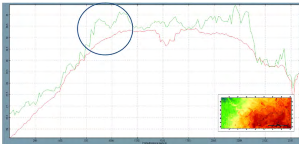
Figuur 7: Dwarsdoorsnede van zuidoost naar noordwest. Groene lijn is de maaiveldhoogte en de rode lijn de berekende freatische grondwaterstand. De blauwe cirkel geeft het gebied BZ1 weer
