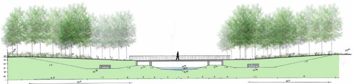
Figuur 5.5 Schetsontwerp kanaalkruising (RHDHV). Doorsnede over kanaal zuidzijde met verbindende duikers aan weerszijden beek.
