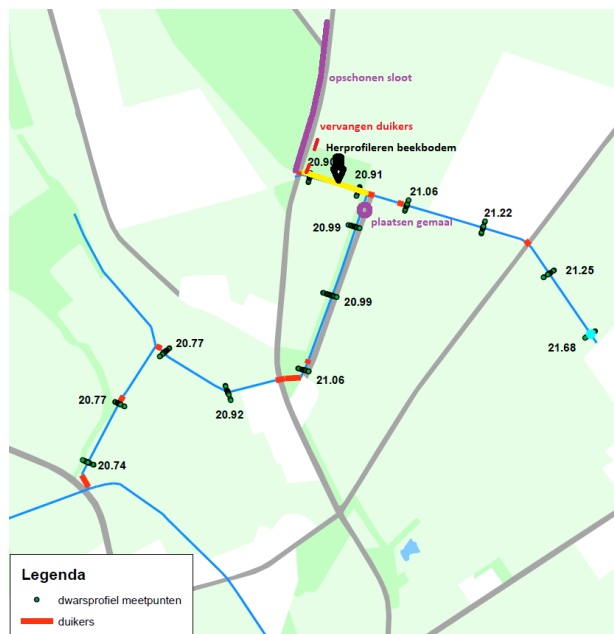
Figuur 5.16 Maatregelen wateroverlast Twelweg.
