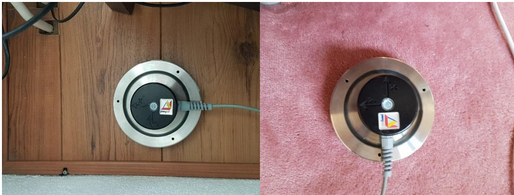
Figuur 8 Trillingssensor op een vast punt op de begane grond (links) en trillingssensor op midden vloerveld bovenste verdieping (rechts). Beide sensoren met de X-richting op de bron gericht
