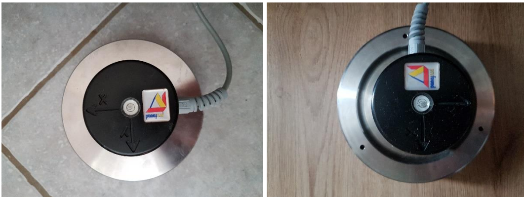
Figuur 5 Trillingssensor op een vast punt op de begane grond (links) en trillingssensor op midden vloerveld bovenste verdieping (rechts). Beide sensoren met de X-richting op de bron gericht.
