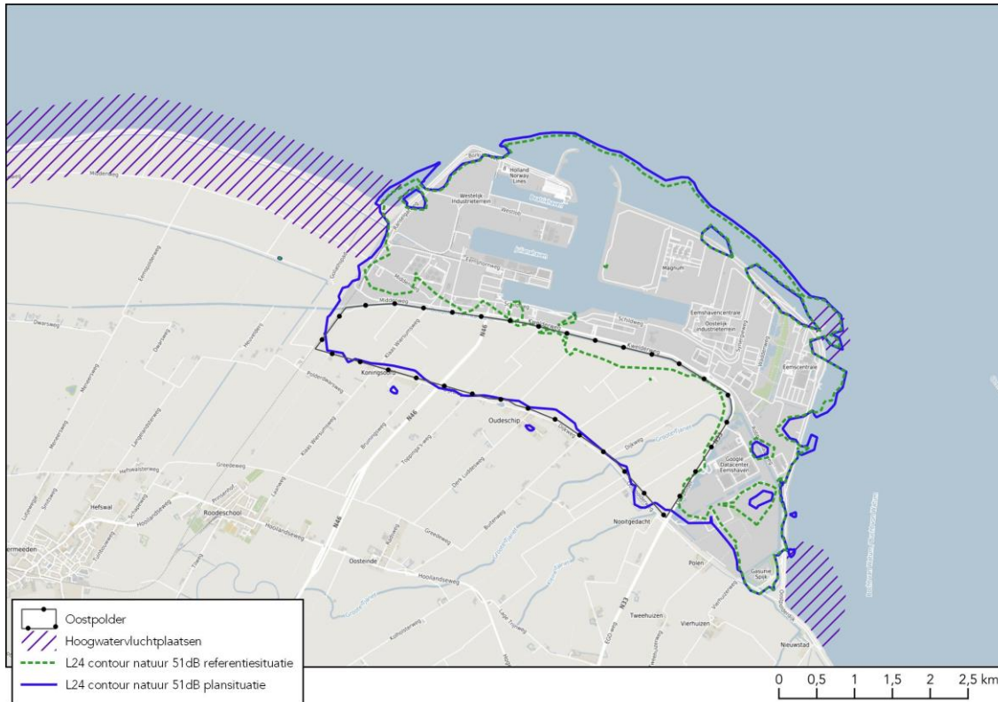
Figuur 20 Geluidcontour van 51 dB(A) Lden in de referentie- en plansituatie, samen met de hoogwatervluchtplaatsen.
