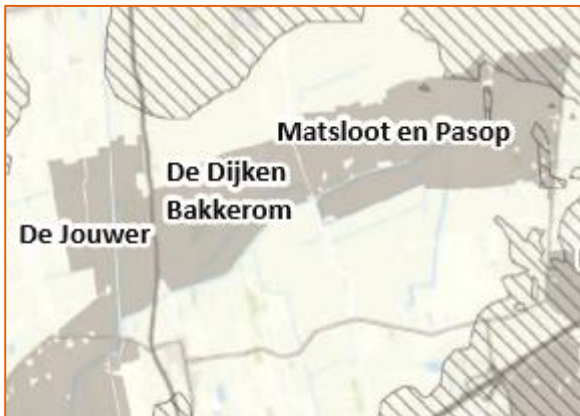
Figuur 9-2 Weerstand in de ondergrond in de omgeving van De Dijken/Bakkerom. In het witte gebied is de weerstand laag, hetgeen suggereert dat daar in de bodem potklei ontbreekt. (Bron: Landschapsanalyse Zuidelijk Westerkwartier, Prolander 2017)
