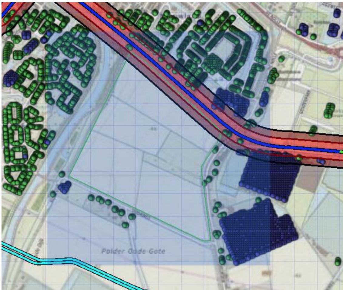
k. Figuur 4.11 Groepsrisico screening voor 7623_leiding-W-538-28-deel-1 van N.V. Nederlandse Gasunie
