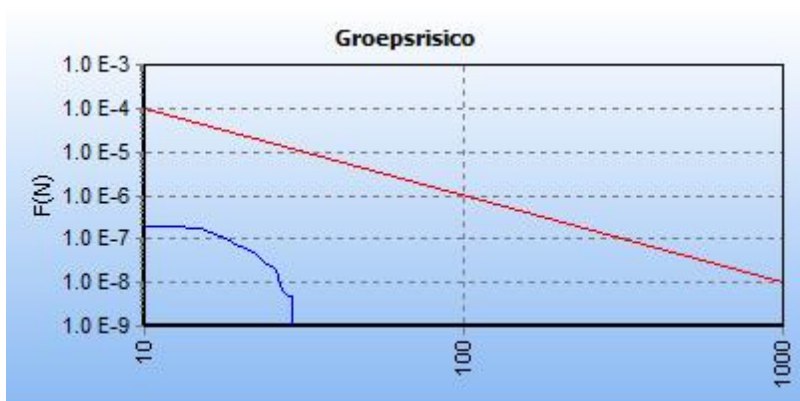
Figuur 25: FN curve voor 7726_leiding-A-536-deel-1 van N.V. Nederlandse Gasunie voor de kilometer tussen stationing 3210.00 en stationing 4210.00
