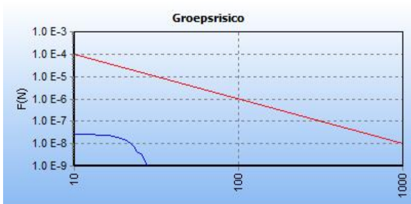
Figuur 24: FN curve voor 7726_leiding-A-624-deel-1 van N.V. Nederlandse Gasunie voor de kilometer tussen stationing 2650.00 en stationing 3650.00
