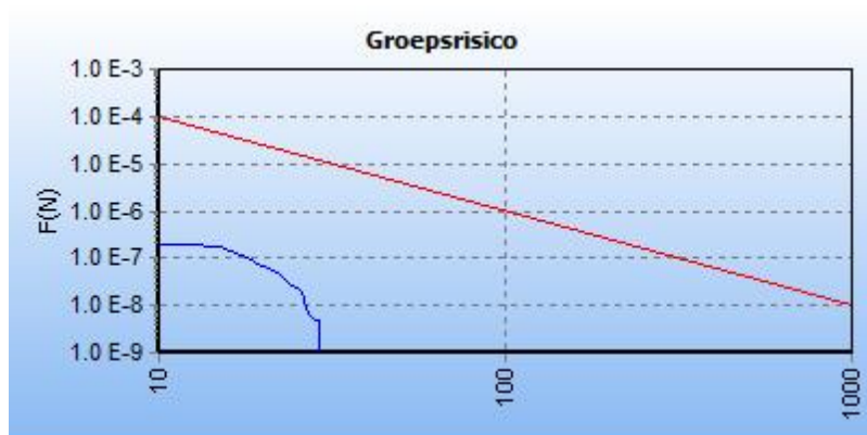
Figuur 28: FN curve voor 7726_leiding-A-536-deel-1 van N.V. Nederlandse Gasunie voor de kilometer tussen stationing 3210.00 en stationing 4210.00
