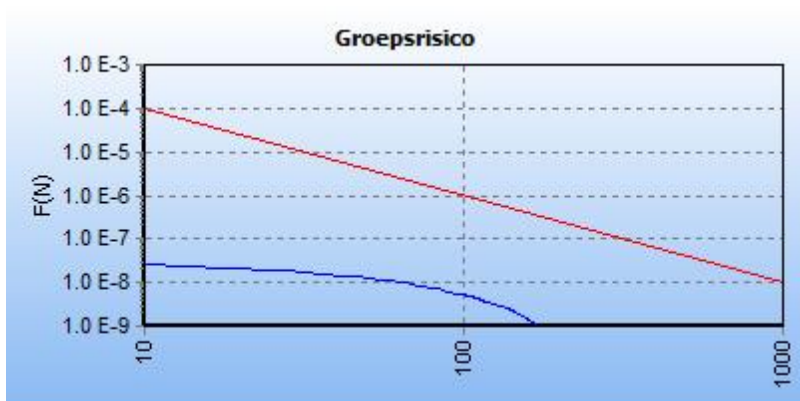
Figuur 26: FN curve voor 7726_leiding-W-538-02-deel-1 van N.V. Nederlandse Gasunie voor de kilometer tussen stationing 2010.00 en stationing 3010.00
