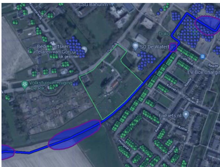
Figuur 8: Plaatsgebonden risico voor 7726_leiding-W-538-02-deel-1 van N.V. Nederlandse Gasunie. Paarse lijn: 10^{-8} -contour.
