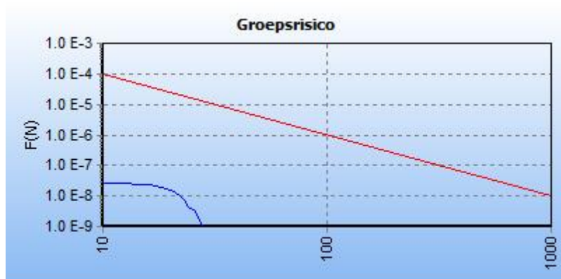
Figuur 27: FN curve voor 7726_leiding-A-624-deel-1 van N.V. Nederlandse Gasunie voor de kilometer tussen stationing 2650.00 en stationing 3650.00
