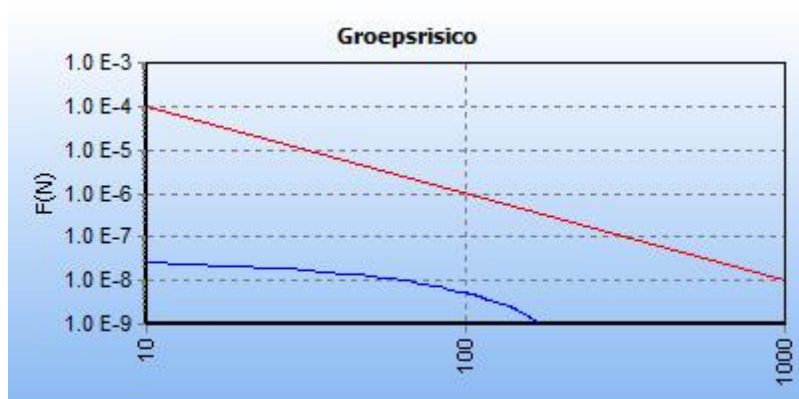
Figuur 23: FN curve voor 7726_leiding-W-538-02-deel-1 van N.V. Nederlandse Gasunie voor de kilometer tussen stationing 2010.00 en stationing 3010.00
