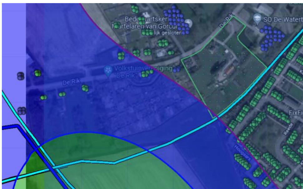
Figuur 9: Plaatsgebonden risico voor 7726_leiding-A-624-deel-1 van N.V. Nederlandse Gasunie. Blauwe lijn: 10^{-7} -contour, paarse lijn: 10^{-8} -contour.
