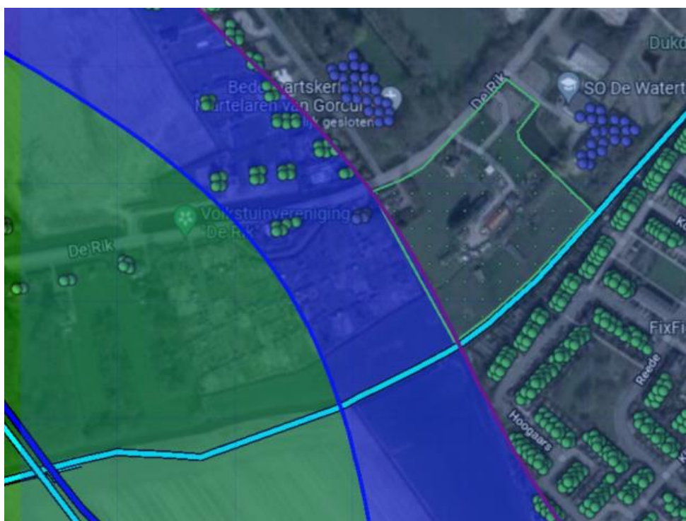
Figuur 10: Plaatsgebonden risico voor 7726_leiding-A-536-deel-1 van N.V. Nederlandse Gasunie. Blauwe lijn: 10^{-7} -contour, paarse lijn: 10^{-8} -contour.
