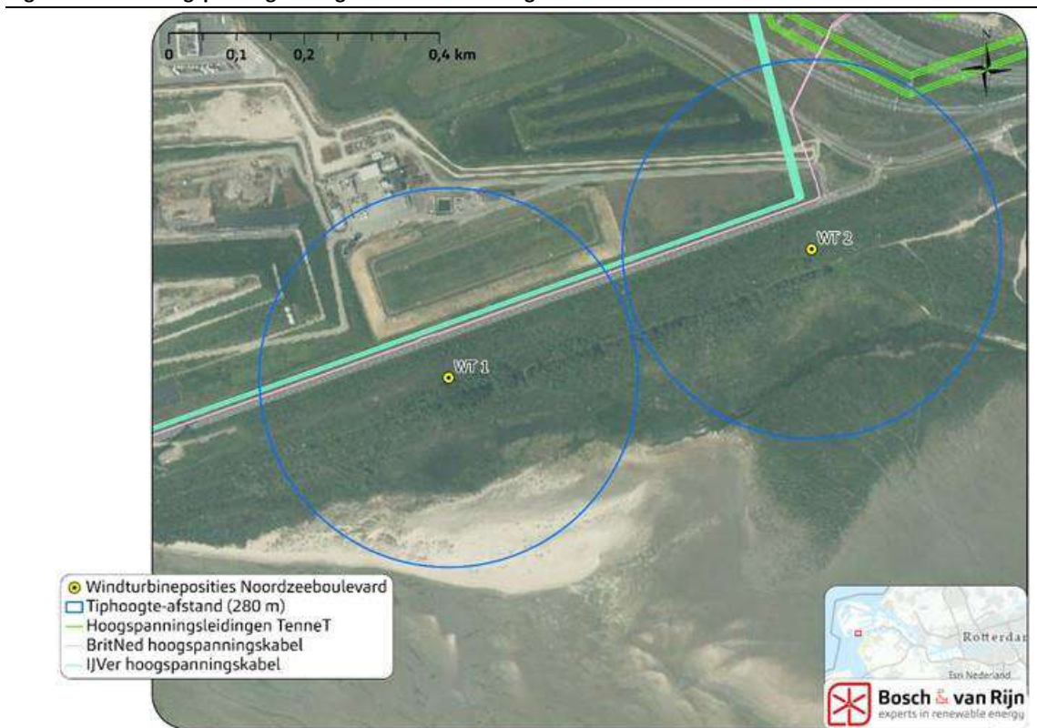
Figuur 21 Hoogspanningsleidingen rondom de beoogde windturbines
