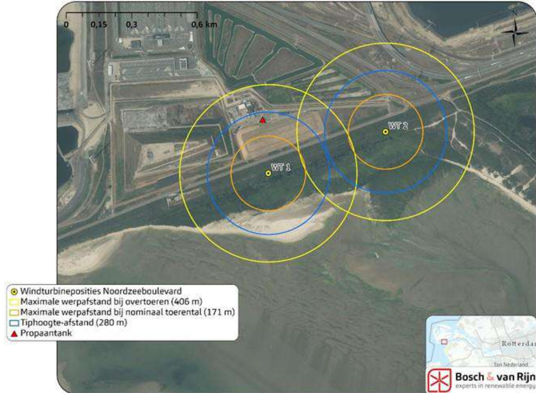
Figuur 18 Risicovolle installaties binnen de invloedssfeer van de beoogde windturbines
