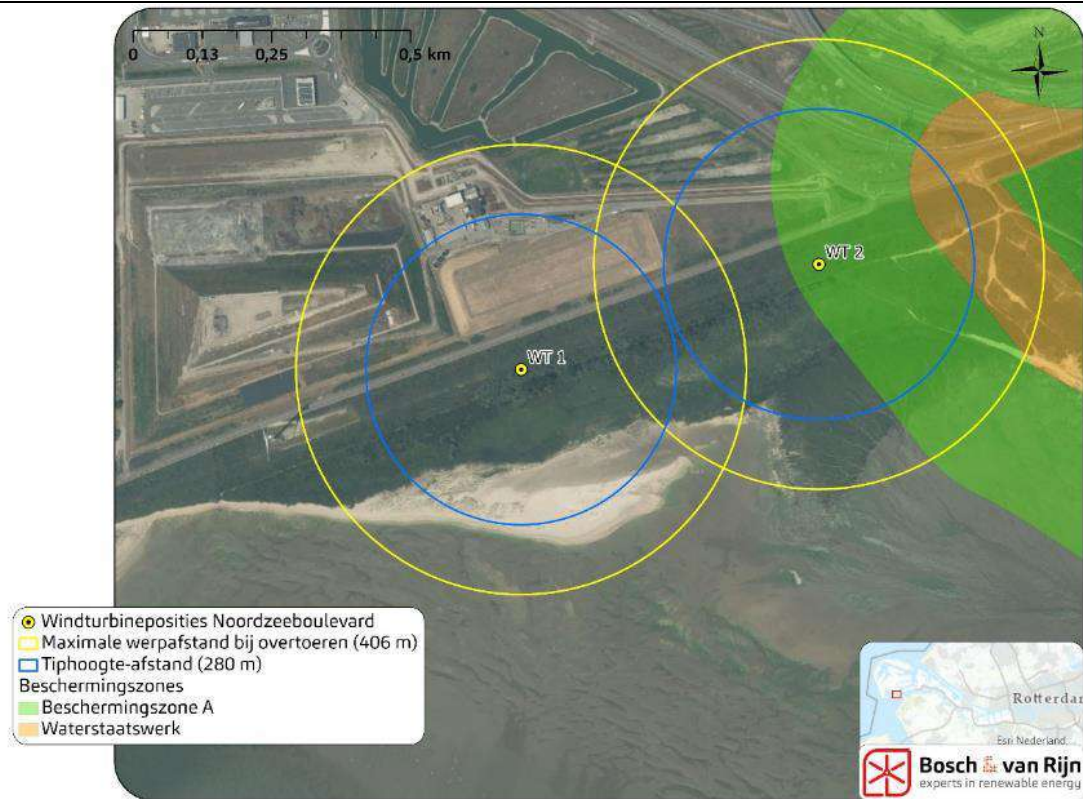
Figuur 10 Waterkeringen rondom de beoogde windturbines.
