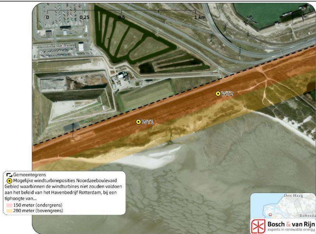
Figuur 17 Gebied waarbinnen de mast van de windturbines niet geplaatst zou kunnen worden om te voldoen aan het beleid van het Havenbedrijf Rotterdam ten aanzien van windturbines.
