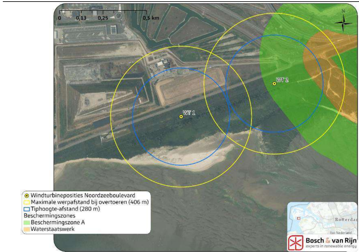
Figuur 22 Waterkeringen rondom de beoogde windturbines.
