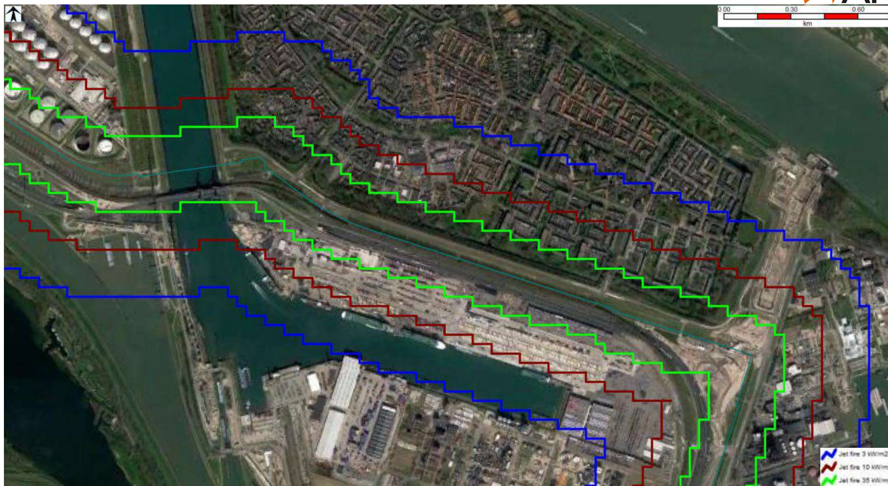
Figuur 15: Het met SAFETI-NL berekende brandaandachtsgebied voor de leidingen ter hoogte van Rozenburg.
