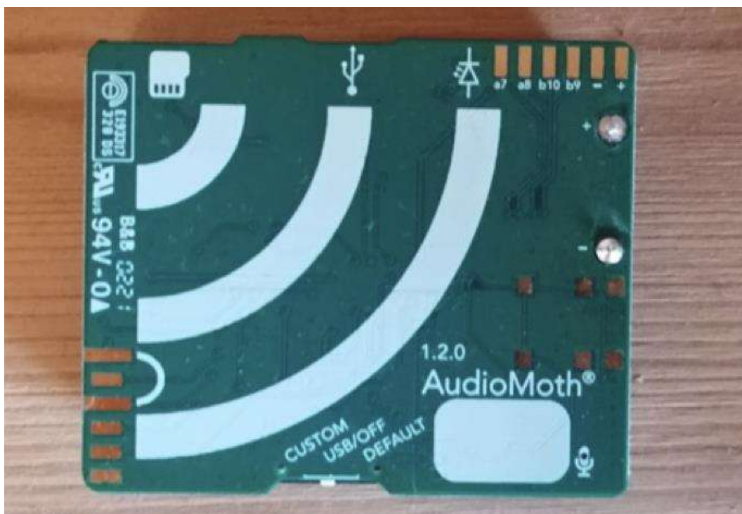
Figuur 5.1 Audiomoth, dit type apparaat is gebruikt in dit onderzoek om aanvullende informatie te verzamelen over migratie van vleermuizen over het projectgebied.
