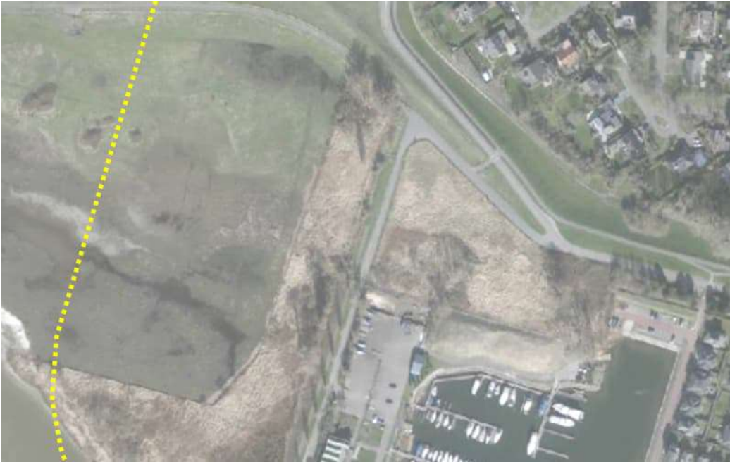
Figuur 3.2 Ligging maximale 47 dB(A)-verstoringcontouren aanlegwerkzaamheden
