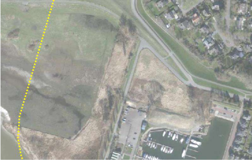
Figuur 3.2 Ligging maximale 47 dB(A)-verstoringcontouren aanlegwerkzaamheden
