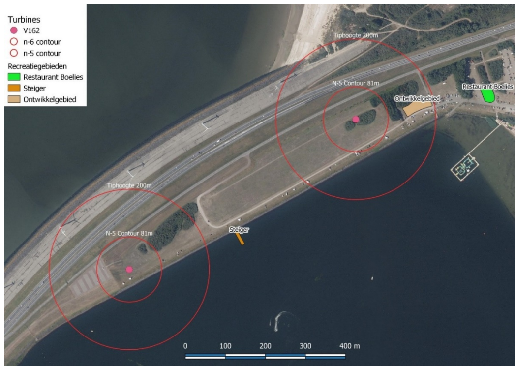
Figuur 1.1 Mogelijke posities van twee windturbines aan de noordoostzijde van de Haringvlietdam (Bron: idverde Advies B.V.). Op de foto zijn ook vier van de zes bestaande windturbines zichtbaar aan overkant van de weg op het buitentalud van de dam.
