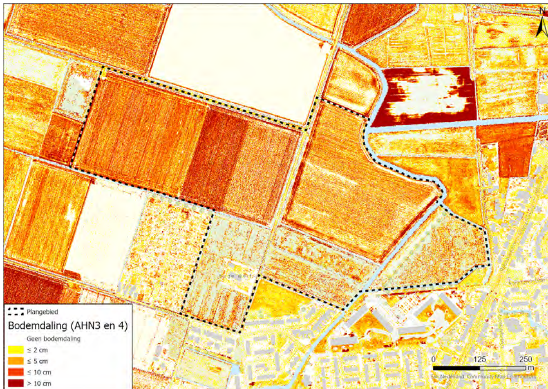
Afbeelding 3.4 Verschil in maaiveldhoogte tussen AHN3 (2017) en AHN4 (2020)
