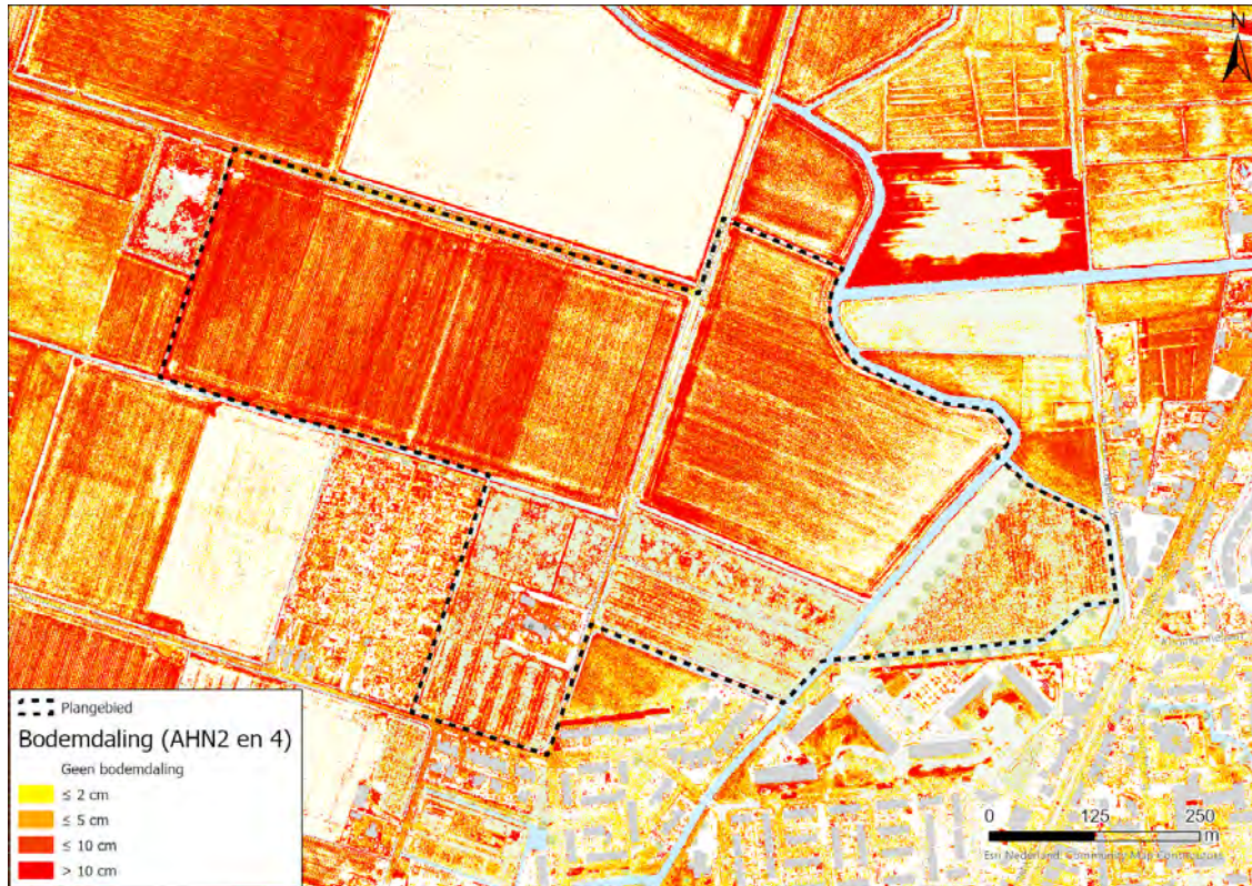
Afbeelding 3.3 Verschil in maaiveldhoogte tussen AHN2 (2008) en AHN4 (2020)
