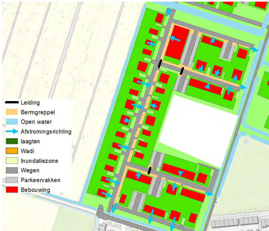
Afbeelding 5.1 Overzicht benutting hemelwaterberging in deelgebied 5A
