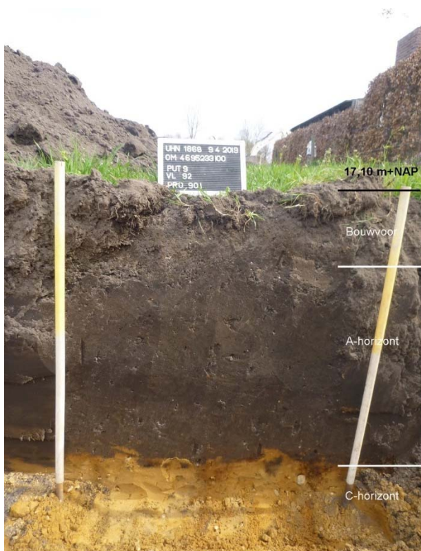
Figuur 5.4 Bodemopbouw op de noordwestelijke overgang (rug-laagte) in profiel 901 (voor ligging, zie Figuur 3.2).
