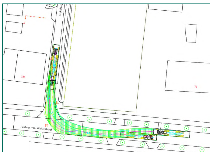
Figuur 2 Rijcurves vrachtwagen Pastoor van Winkelstraat - Broksteeg
