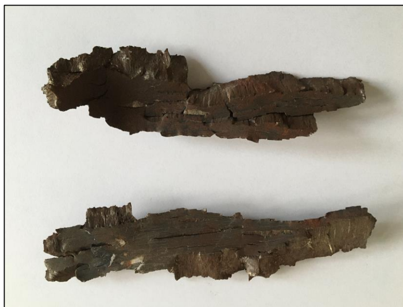
Afbeelding 45: Scherven na detonatie van een met springstof gevuld OO.
