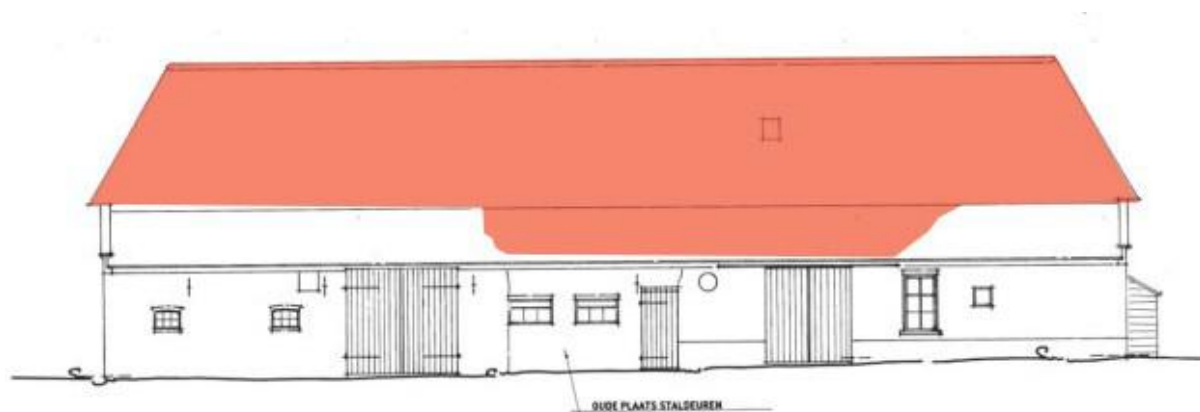
Figuur 8 - De rechter zijgevel zoals die oorspronkelijk was. In rood het gedeelte dat inmiddels is ingestort. Het betreft een groot deel van het dak (opmetingstekening Van Hooft Architecten, 2008).
