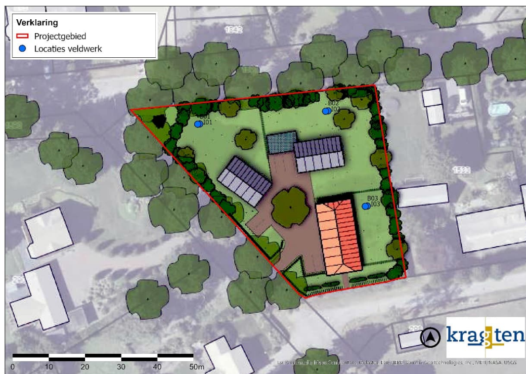
Figuur 9 locaties boringen en infiltratiemetingen
