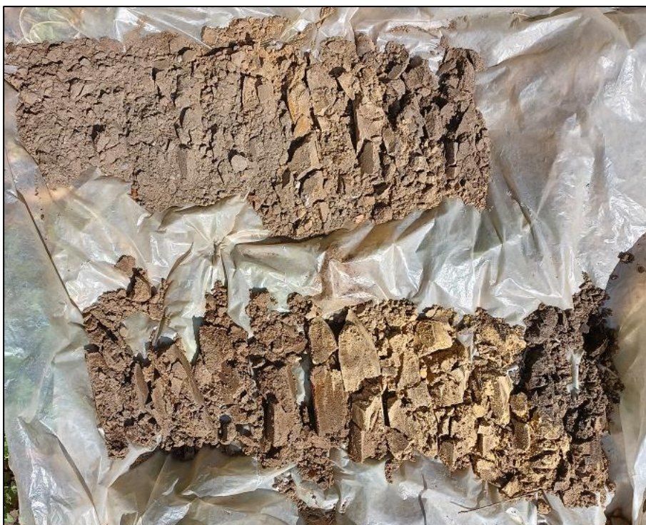
Figuur 10. Boorprofiel boring 5, deel 1. Leesrichting van linksboven naar rechtsonder. 0 tot 100 cm -mv.
