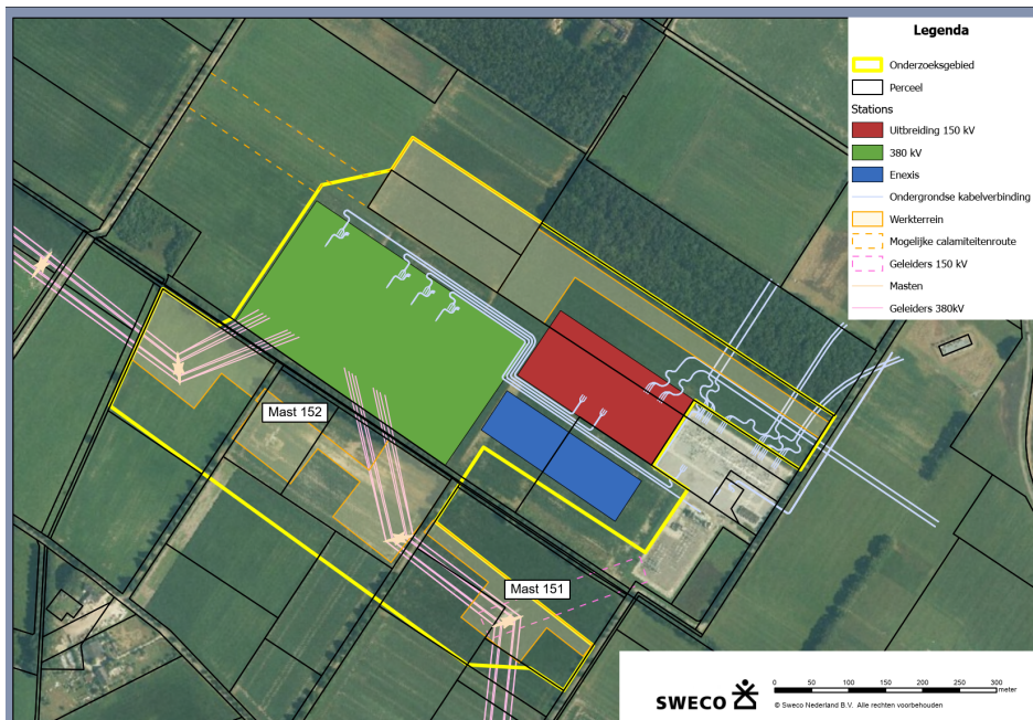
Figuur 1.2 Tekening met de locaties van de nieuwe stations (gekleurde vlakken), werkwegen en werkterreinen (oranje vlakken). De witte lijnen betreffen ondergrondse kabels.
