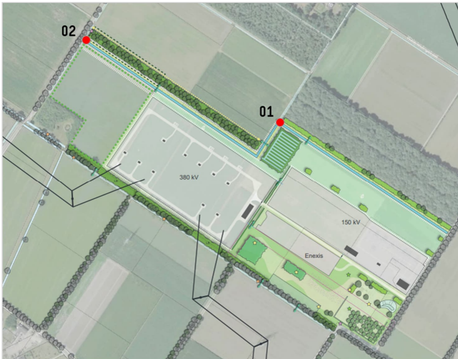
Figuur 11: Uitsnede landschappelijk inpassingsplan met ligging stations, watergang en stuwen (rode cirkels).
