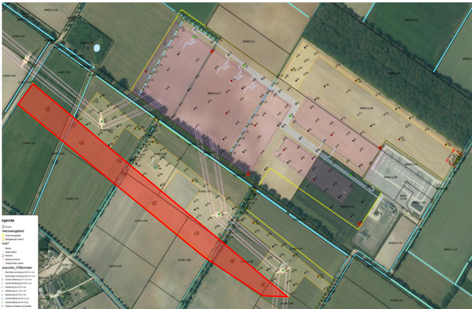
Figuur 1.2 Tekening met de locaties van de nieuwe stations (roze vlakken), werkwegen (oranje vlakken). De witte lijnen betreffen ondergrondse kabels. Het rode vlak betrof de tijdelijke masten, maar deze worden niet meer aangebracht en vervallen.
