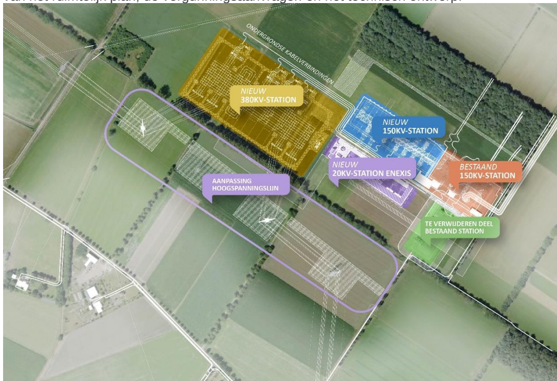
Figuur 1.1 Geplande werkzaamheden hoogspanningsstation Boxmeer.
