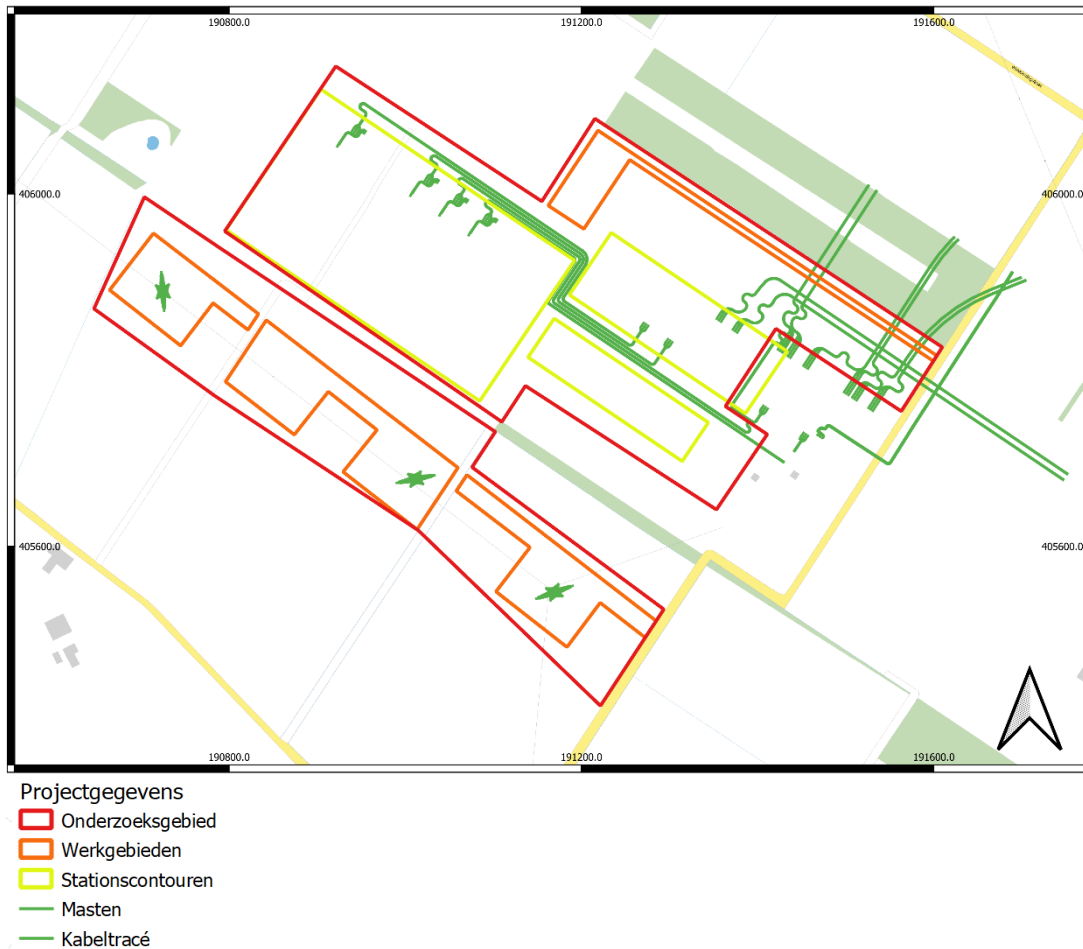
Figuur 2: De geplande werkzaamheden binnen het plangebied
