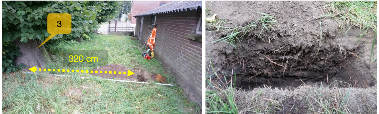
Foto 4: Overzichtsfoto en detailfoto van profielsleuf bij boomnummer 3. De geel gestreepte pijl geeft de afstand tussen profielsleuf en hart stam weer. Op de detailfoto is een intensieve fijne beworteling zichtbaar, dit tot een diepte van 60 cm -mv.
