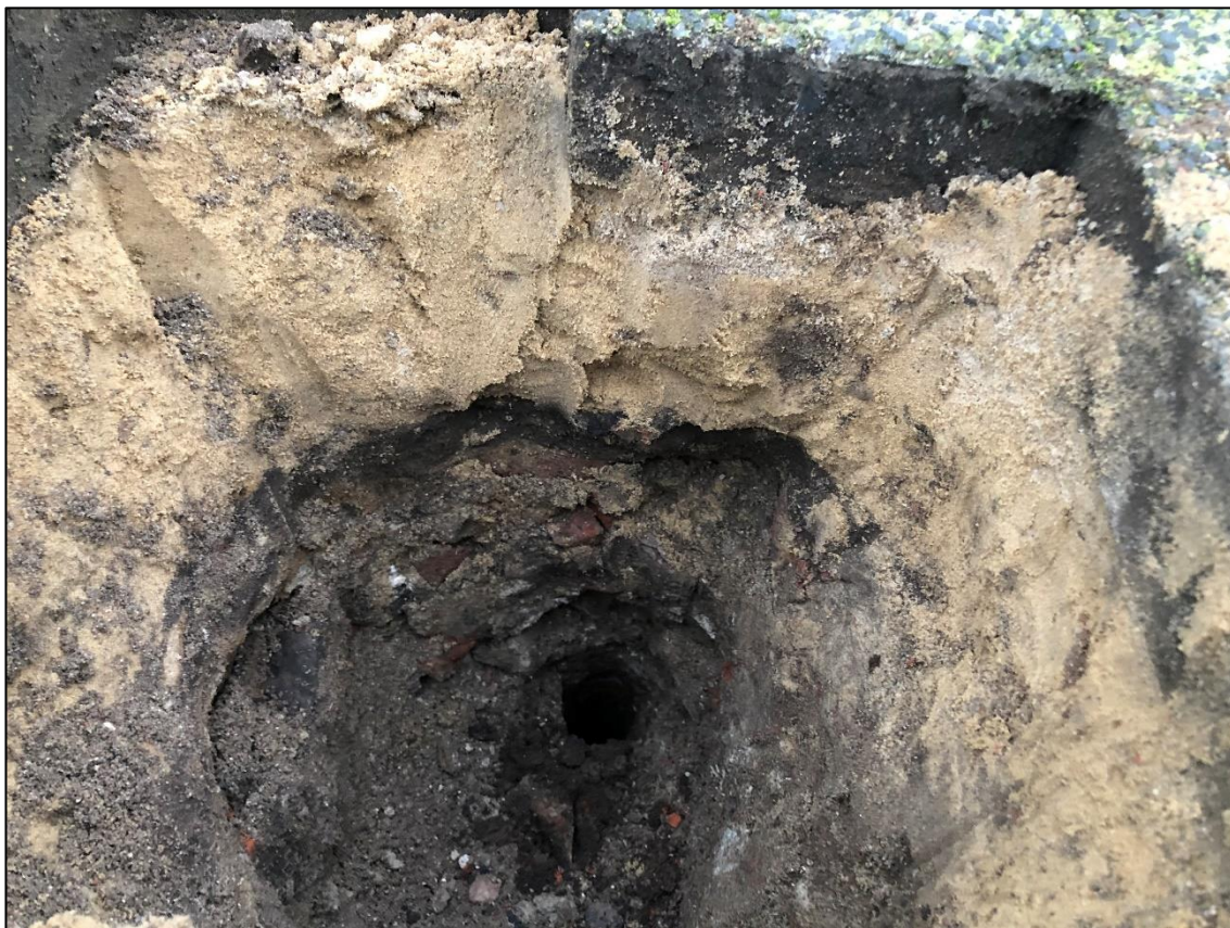
Figuur 119: Puin in het kijkgat van boring 1.
