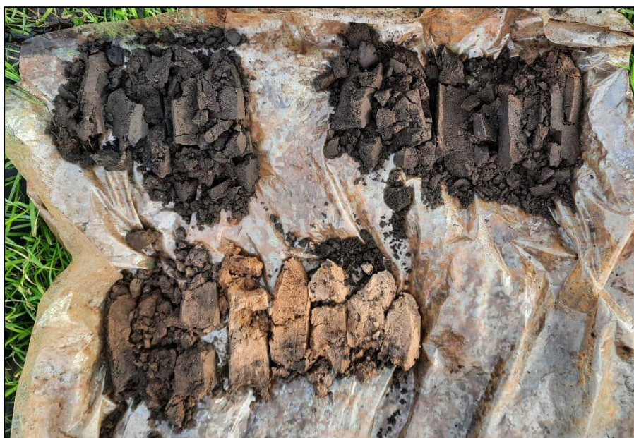
Figuur 7. Boorprofiel van boring 15. De leesrichting is van linksboven naar rechtsonder (0 – 160 centimeter) (Foto: 25 januari 2024).
