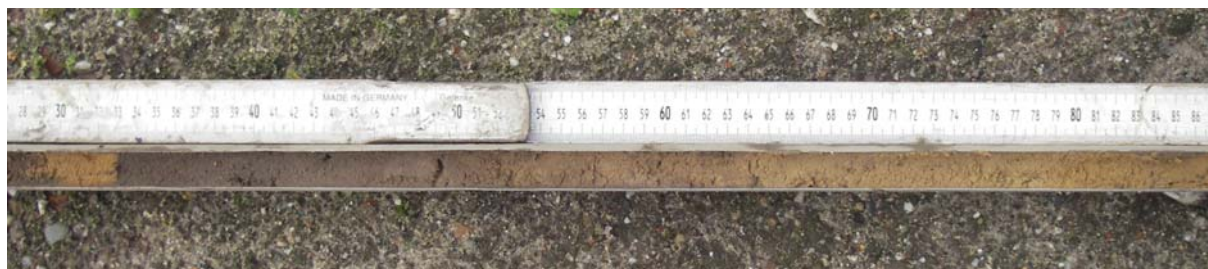
Figuur 5: Een duidelijk zichtbare brok schoon geel zand in de humusrijke toplaag van boring 3 (rond 30 cm -Mv). De humusrijke toplaag in deze boring loopt tot 52 cm -Mv en het licht humeuze zand loopt door tot 64 cm -Mv.
