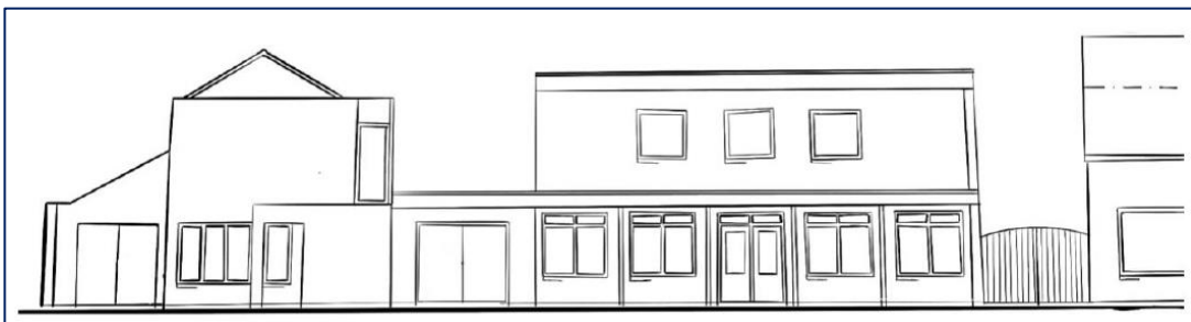
Aanzicht voorgevel na sloop gebouwdeel boven garage
