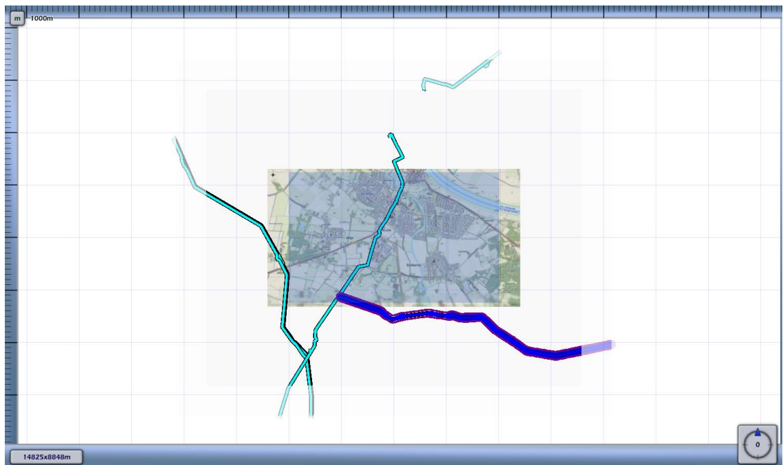
3.8 Figuur 3.8 Plaatsgebonden risico voor 7663_leiding-Z-542-17-deel-1 van N.V. Nederlandse Gasunie
