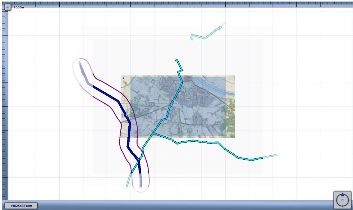
3.6 Figuur 3.6 Plaatsgebonden risico voor 7663_leiding-N-576-75-deel-1_excl verl van N.V. Nederlandse Gasunie
