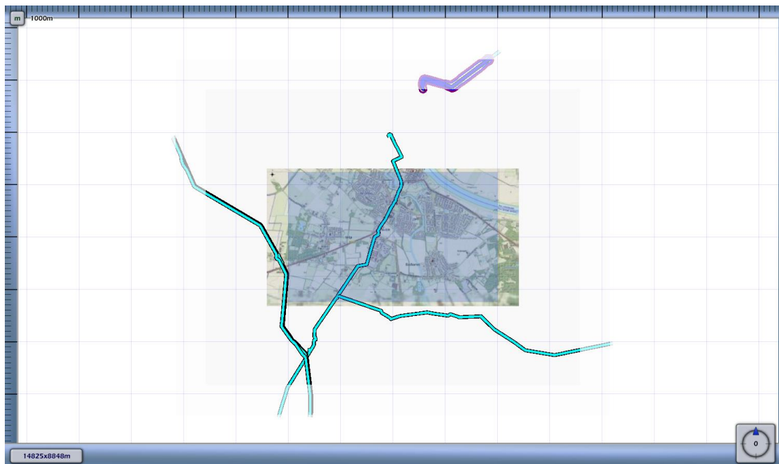
3.6 Figuur 3.6 Plaatsgebonden risico voor 7663_leiding-N-576-75-deel-1_excl verl van N.V. Nederlandse Gasunie
