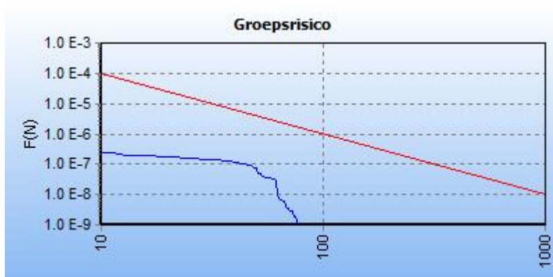
5.8 Figuur 5.8 FN curve voor 7663_leiding-Z-542-17-deel-1 van N.V. Nederlandse Gasunie voor de kilometer tussen stationing 0.00 en stationing 1000.00
