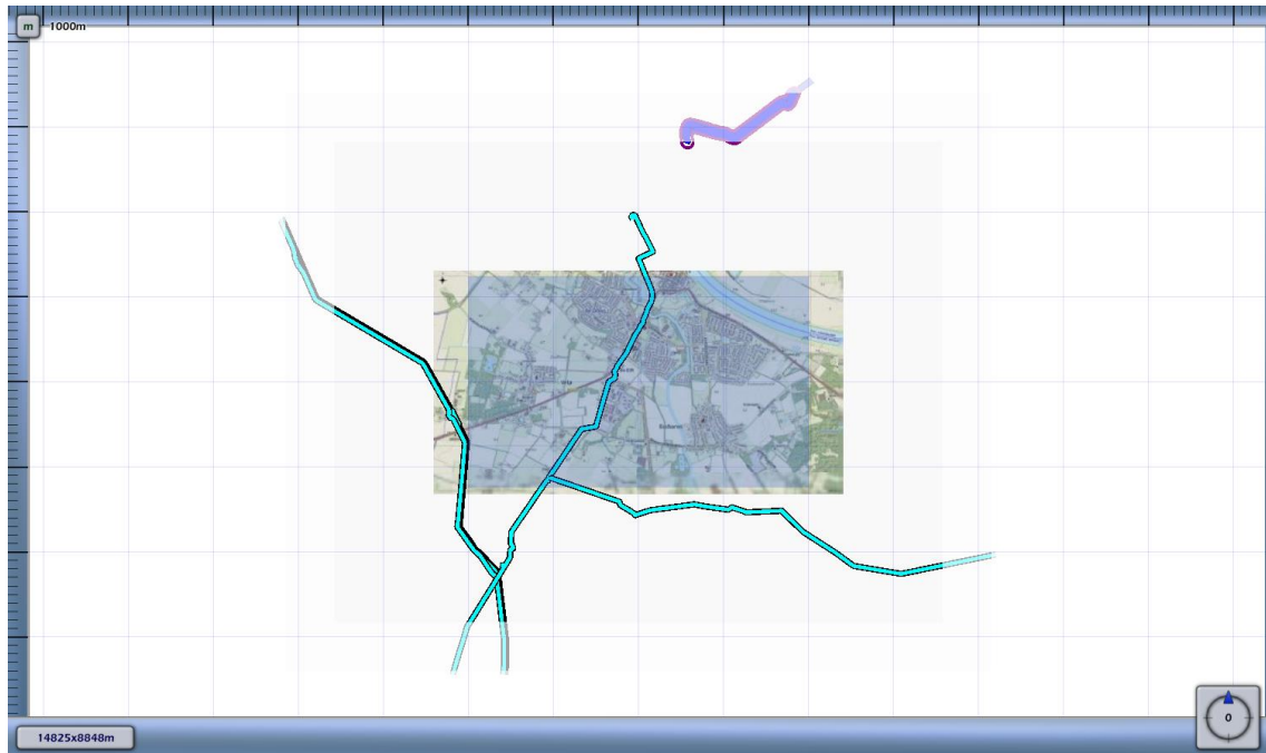
3.9 Figuur 3.9 Plaatsgebonden risico voor 7664_leiding-N-576-75-deel-1_incl verl van N.V. Nederlandse Gasunie
