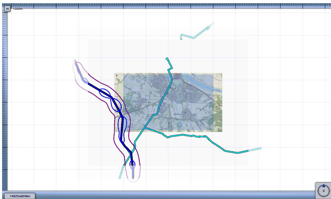
3.4 Figuur 3.4 Plaatsgebonden risico voor 7663_leiding-A-587-deel-1 van N.V. Nederlandse Gasunie
