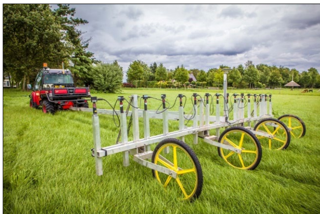
Figuur 3. Passieve non realtime oppervlakedetectie met het Vallon Multisondesysteem VXV16 en een staafdiagram waarop het maximale detectiebereik ( m^3 – maaiveld) per kaliber.
