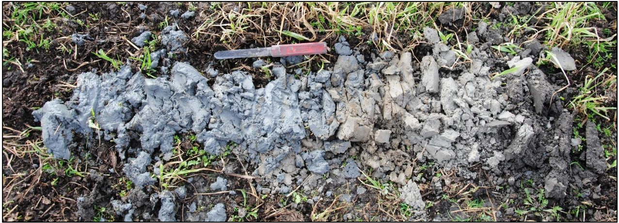
Afbeelding 12. De opbouw van de bodem binnen het plangebied. Rechts de teellaag, links daarvan getij-afzettingen van sterk siltig zand
