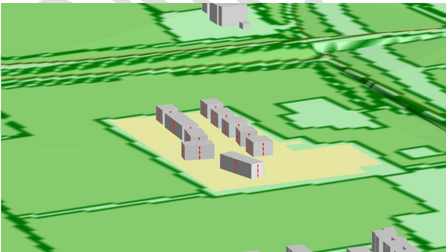
Figuur 4: 3D-weergave van het geluidmodel met toetspunten op de proefverkaveling.
