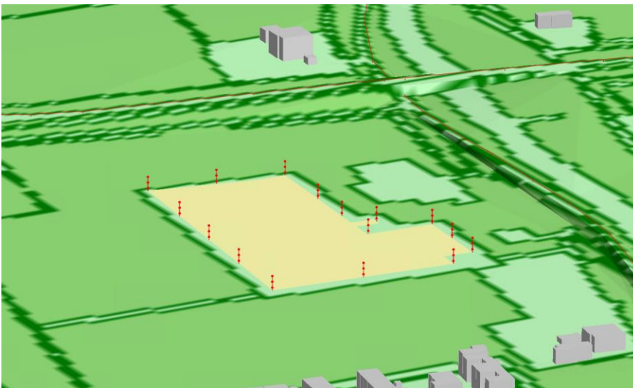
Figuur 3: 3D-weergave van het geluidmodel met toetspunten op de plangrens.
