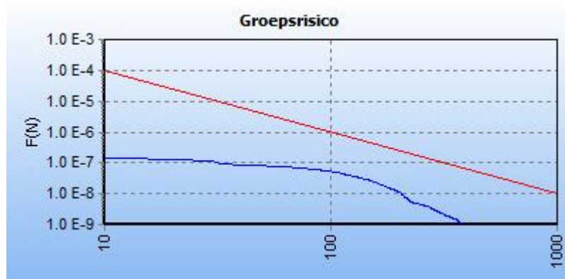
5.1 Figuur 5.1 FN curve bestaande situatie voor 8719_leiding-N-509-40-deel-1 van N.V. Nederlandse Gasunie voor de kilometer tussen stationing 3370.00 en stationing 4370.00
