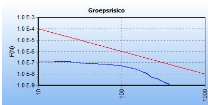
5.2 Figuur 5.2 FN curve nieuwe situatie voor 8719_leiding-N-509-40-deel-1 van N.V. Nederlandse Gasunie voor de kilometer tussen stationing 3370.00 en stationing 4370.00
