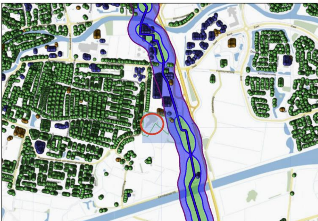
Figuur 3.1 Plaatsgebonden risico voor 8719_leiding-N-509-40-deel-1 van N.V. Nederlandse Gasunie
