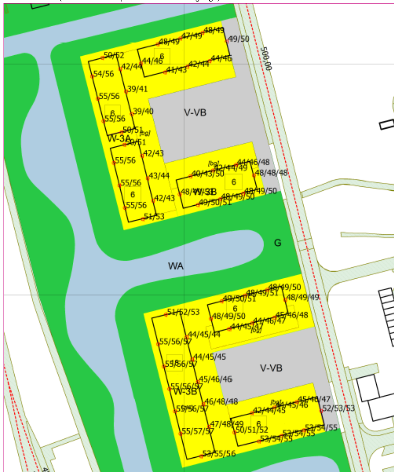
Figuur 5.4: overzicht van de berekende cumulatieve geluidbelasting L_{den} in dB vanwege wegverkeerslawaai (exclusief aftrek op basis van artikel 110g Wgh)
