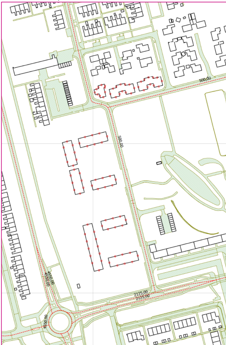
Figuur 4.1: overzicht van het akoestisch rekenmodel met de ligging van objecten, bodemvlakken en de toets-/rekenpunten
