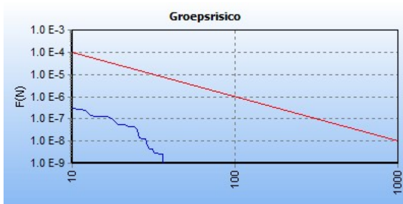
Figuur 11: Groepsrisico leiding N-509-90 met invulling voormalige LTS locatie aan de Hogelandsterweg te Delfzijl
