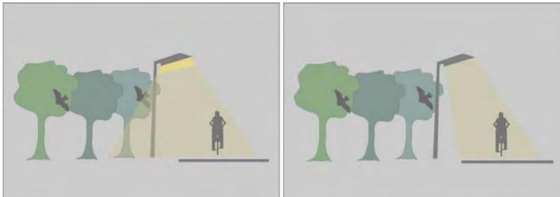
Figuur 8.1: Voorbeeld gerichte verlichting. Links: ongerichte verlichting. Rechts: gerichte verlichting waarbij lichtverstoring wordt voorkomen. (Bron: Zoogdiervereniging, 2013)
