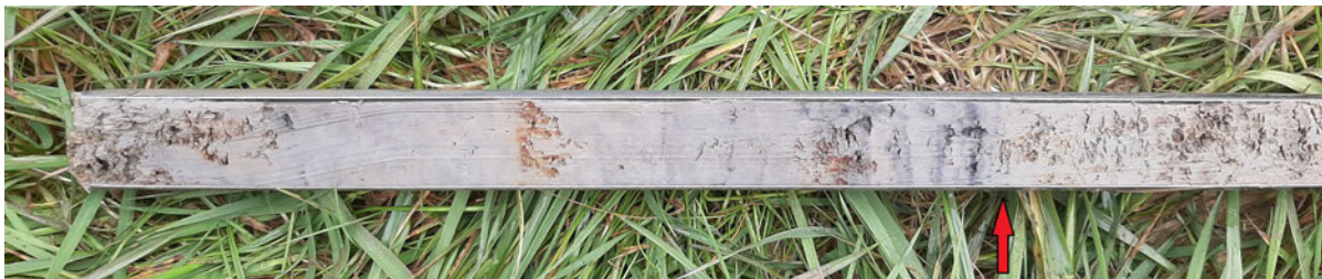
Figuur 14: Meedhuizen, Geefsweersterweg 9: gutsmonster boring 18. De pijl wijst naar een diepte van 62 centimeter. Links daarvan zeer zware klei met vooral bovenin een concentratie van brandlagen. Rechts van de pijl een jonger dek van matig zware klei zonder brandlagen.
