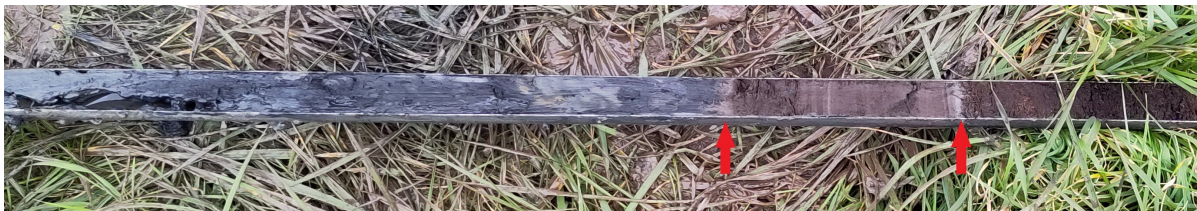
Figuur 13: Meedhuizen, Tussen Meedhuizerweg 24-26: gutsmonster boring 15. De overgang van de blauwgrijze naar bruine klei naar het veen is goed zichtbaar.
