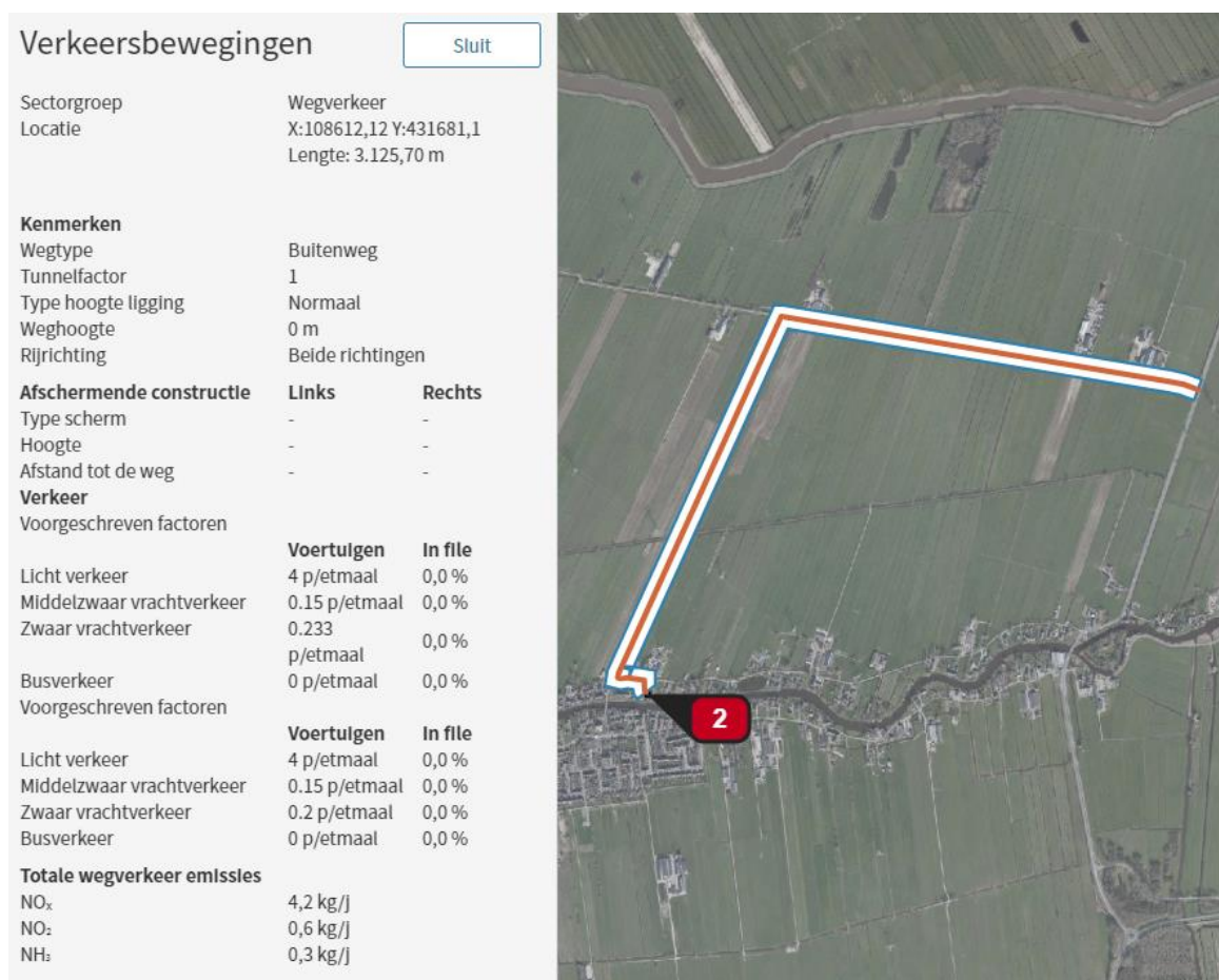
Figuur 8 – aanlegfase, verkeersbeweging en rijroute
