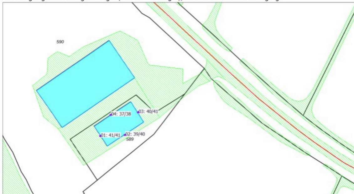
Afbeelding V: geluidbelasting alle wegen (incl. 30 km/h wegen), incl. aftrek conform art. 110g Wgh
