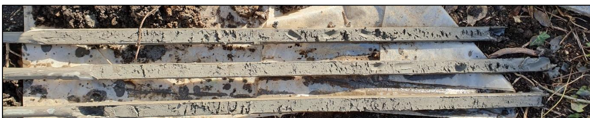
Boring 1. Boven: 0-350 cm -Mv. Onder: 350 – 650 cm -Mv.
