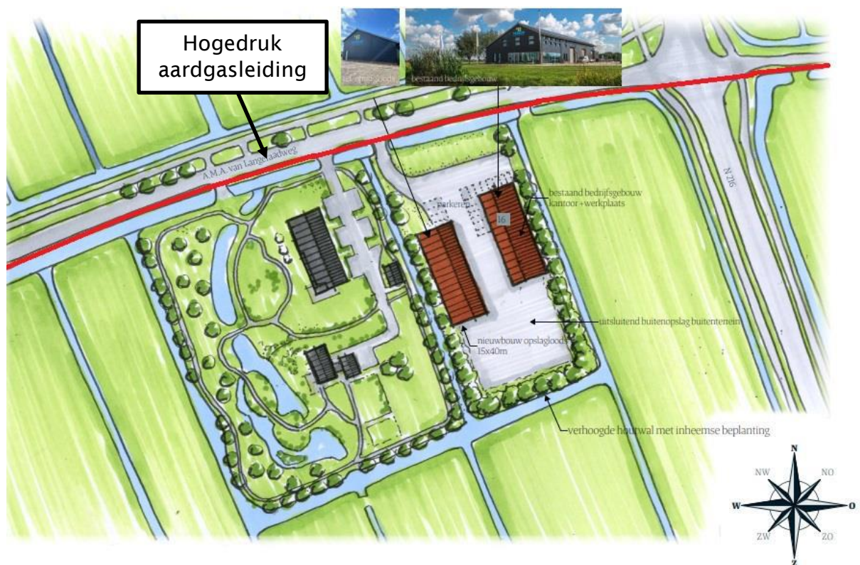
Afbeelding 10: Inrichtingsschets met in rood de hogedruk aardgasleiding
