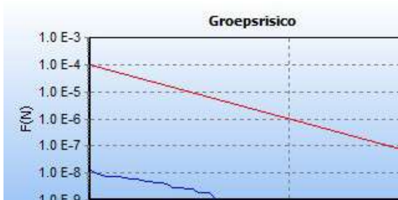
5.2 Figuur 5.2 FN curve voor 8516_leiding-A-553-deel-1 van N.V. Nederlandse Gasunie voor de kilometer tussen stationing 4210.00 en stationing 5210.00
