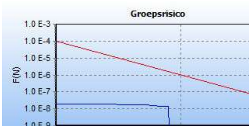
5.2 Figuur 5.2 FN curve voor 8516_leiding-A-553-deel-1 van N.V. Nederlandse Gasunie voor de kilometer tussen stationing 3140.00 en stationing 4140.00
