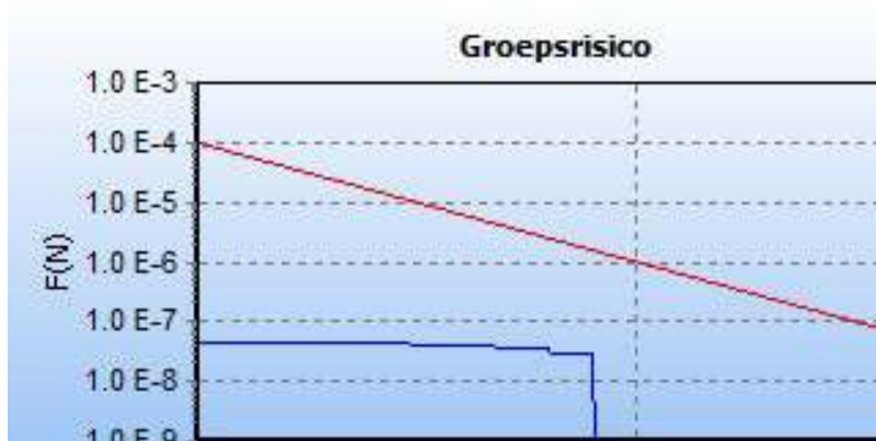
5.2 Figuur 5.2 FN curve voor 8516_leiding-A-553-deel-1 van N.V. Nederlandse Gasunie voor de kilometer tussen stationing 3140.00 en stationing 4140.00
