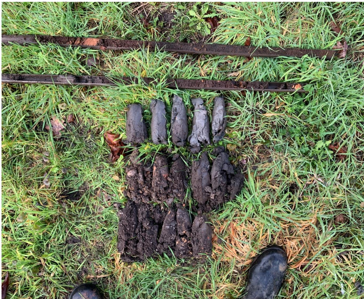
Foto's van boring 2 (onderste rij, 0-50, naar boven toe per 50 cm). De gutsen van onder naar boven, van 150-200 en 200-300 cm -Mv.
