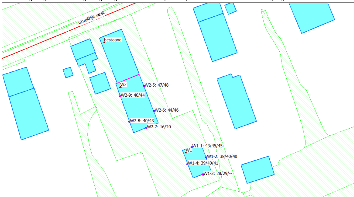
Afbeelding III: geluidbelasting ten gevolge van de Graafdijs-West, incl. aftrek conform art. 110g Wgh
