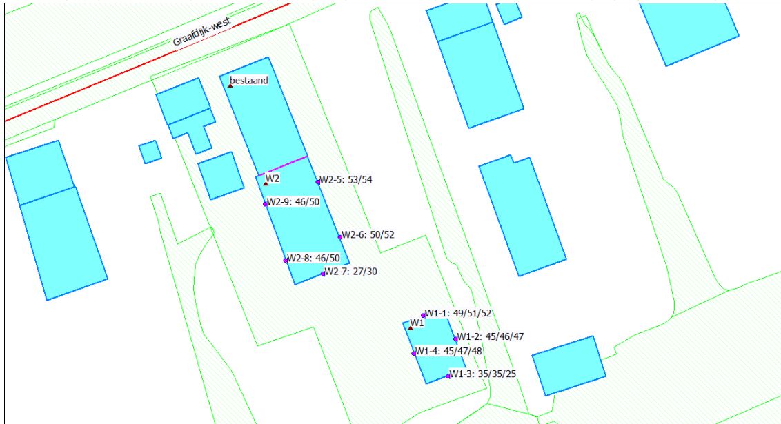
Afbeelding VI: gecumuleerde geluidbelasting ten gevolge van alle wegen, excl. aftrek art. 110g Wgh (gevelmaatregelen)
