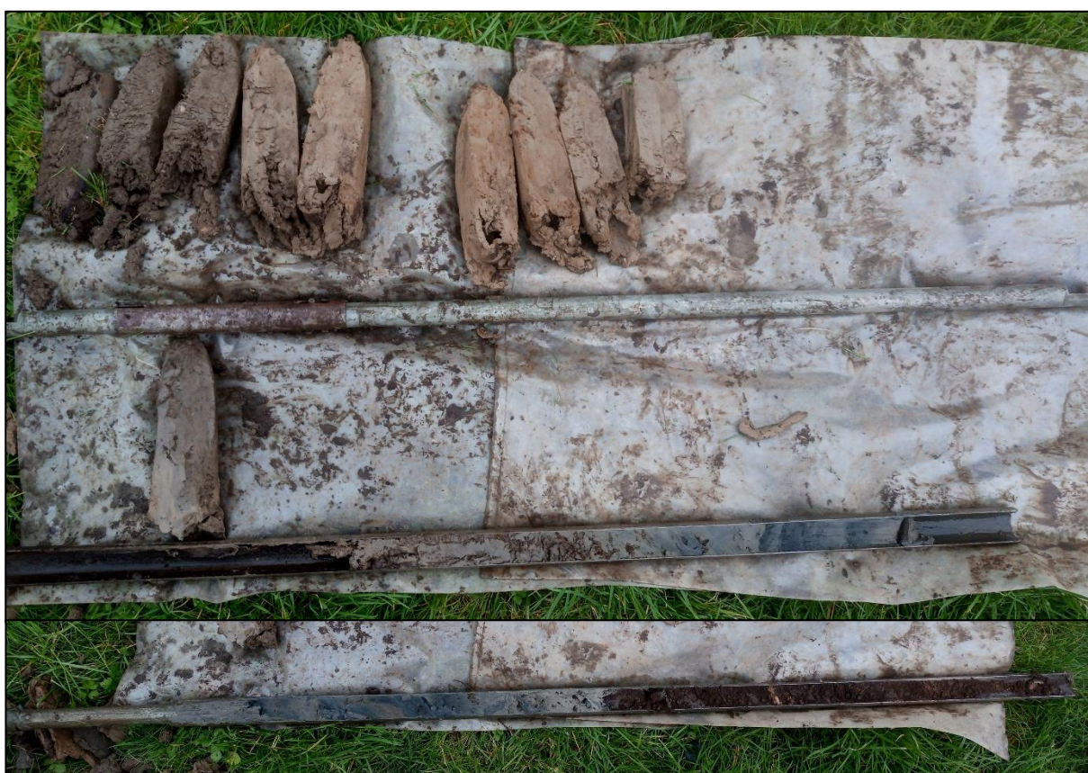
Boring 5. Boven: 0-200 cm -Mv. Onder: 200-300 cm -Mv.
