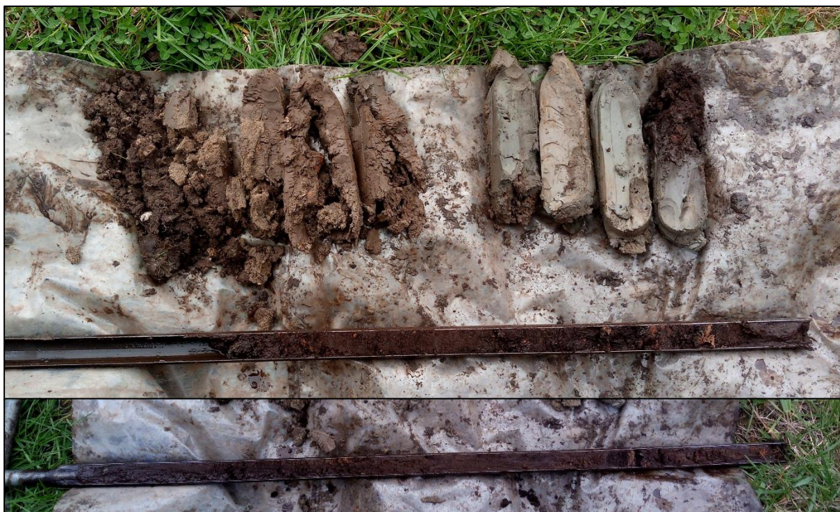
Boring 2. Boven: 0-200 cm -Mv. Onder: 200-300 cm -Mv.
