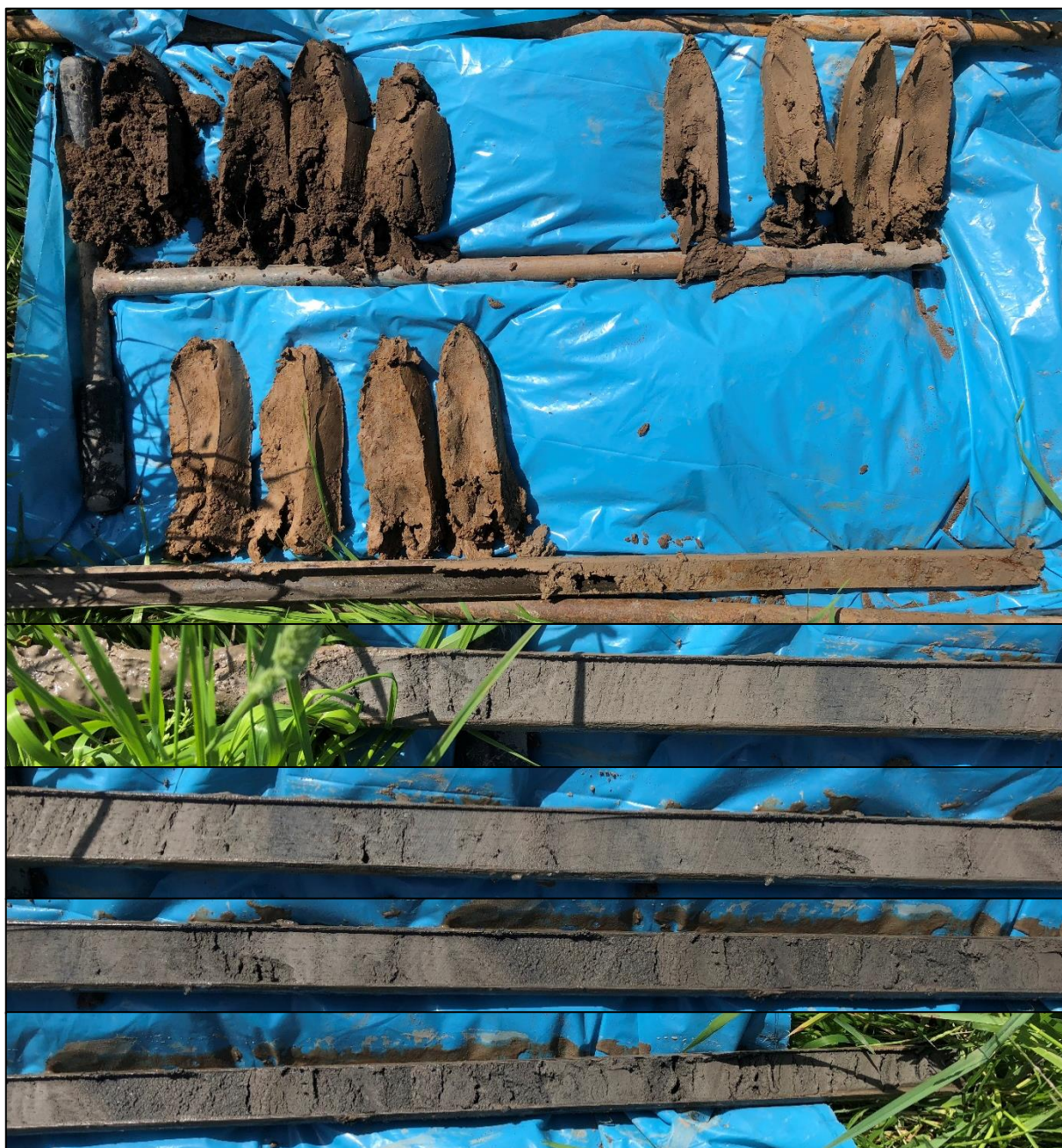
Boring 5: 0-300 cm -Mv, met detailopnames van het traject geulvulling.
