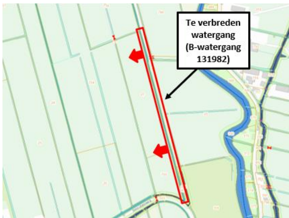
Afbeelding 18: De te verbreden watergang aan de Smoutjesweg (watercompensatie)
